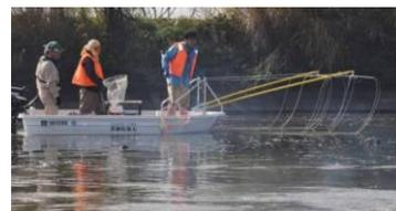
⑤電気ショッカーボート：電気でしびれた外来魚を捕獲するもの。駆除効率が高い。
